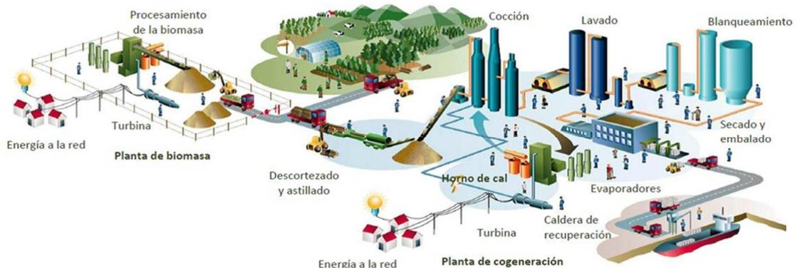
Imagen 5.2.1: Proceso de fabricación de pasta de papel y producción de energía eléctrica desarrollado por ENCE.
